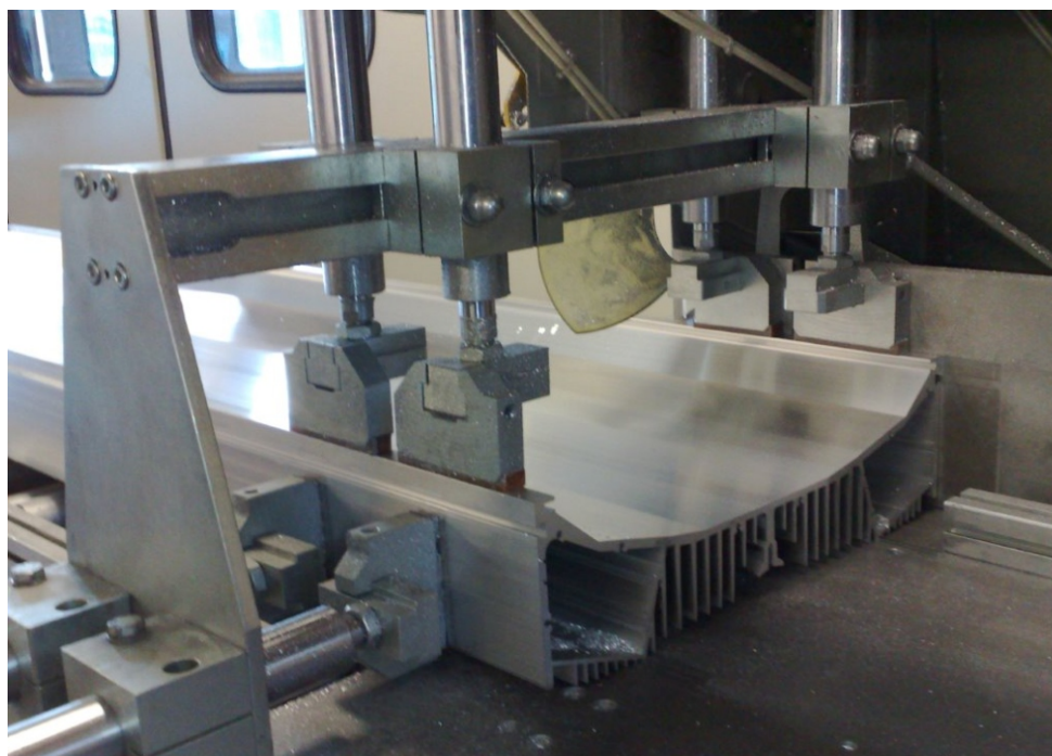
FOTO DI ESEMPIO: TAGLIO DI PROFILI IN ALLUMINIO ANCHE DI GRANDI DIMENSIONI
