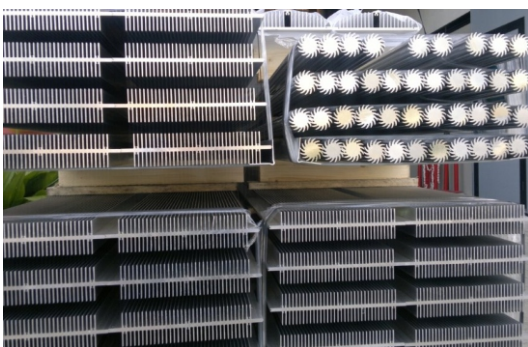
FOTO DI ESEMPIO: PROFILI IN ALLUMINIO DISSIPATORI PIANI DISSIPATORI TONDI FLOWER ALETTATI
