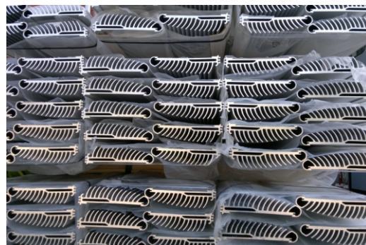
FOTO DI ESEMPIO: PROFILI IN ALLUMINIO DISSIPATORI PIANI DISSIPATORI TONDI FLOWER ALETTATI
