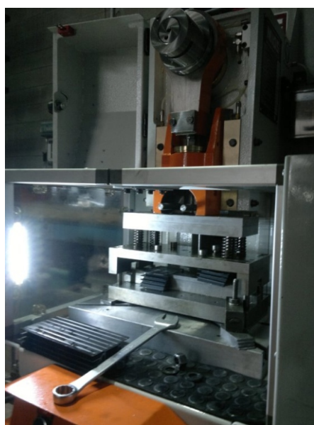
FOTO DI ESEMPIO: SI ESEGUONO OPERAZIONI DI TRANCIATURA SU PROFILI ESTRUSI IN ALLUMINIO
